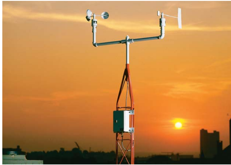
그림 6-24 | 풍향계(오른쪽)와 풍속계(왼쪽). 풍향계는 바람의 방향을, 풍속계는 바람의 속력을 측정한다.(사진 : Belfort Instrument Company)
